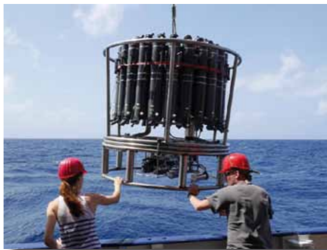
Ein Kranwasserschöpfer wird vom Forschungsschiff METEOR aus ins Wasser gelassen. Die Autoren der aktuellen Studie haben hundertausende Sauerstoffmessungen weltweit ausgewertet. Foto: Martin Visbeck, GEOMAR
