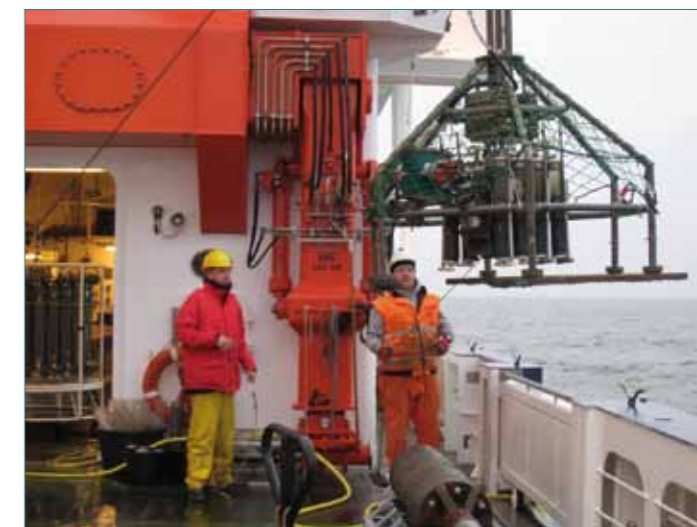
Mit Hilfe eines Multicorers sammelten Jessen und seine Kollegen Sedimentkerne, anhand derer sie detaillierte Untersuchungen der Zusammensetzung und Besiedlung des Meeresbodens durchführen konnten. Bild Ryan North, Eawag
