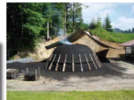
Der fertige, mit Reisig- und Löschiemantel abgedichtete Holzkohle-Meiler in Aktion.
