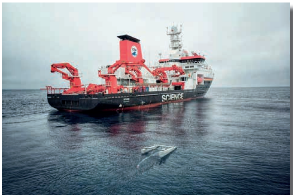
Neustonnetz, das an der Seite des deutschen Forschungsschiffs SONNE auf der Expedition über den Nordpazifik geschleppt wird, um an der Oberfläche schwimmende Plastikproben zu sammeln. © Philipp Klöckner / UFZ
