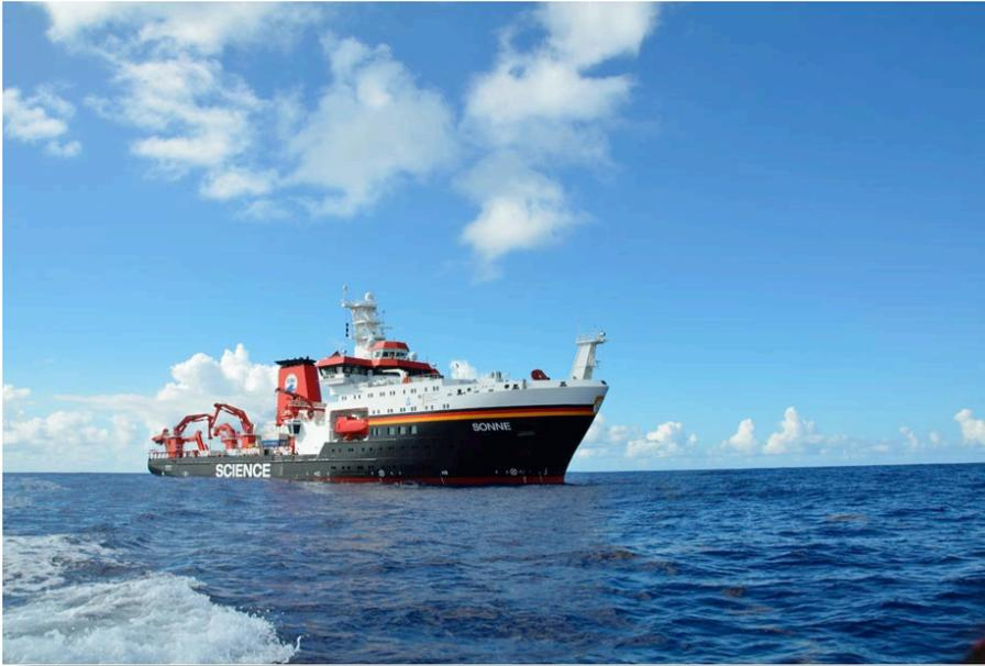
**Das deutsche Tiefsee-Forschungsschiff «Sonne». Es hat modernste Meerestechnik an Bord, darunter autonome und ferngesteuerte Unterwasserfahrzeuge, Landefähren, geschleppte Geräte sowie Greifersysteme.**
