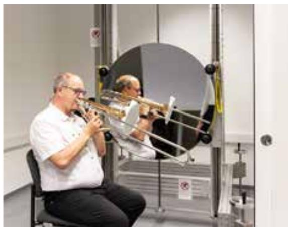
Durch den Einsatz eines einfachen Filters beim Spielen von Blechblasinstrumenten wird die Reichweite der Atemluft stark reduziert. © Carolin Klemm, Bauhaus-Universität Weimar
