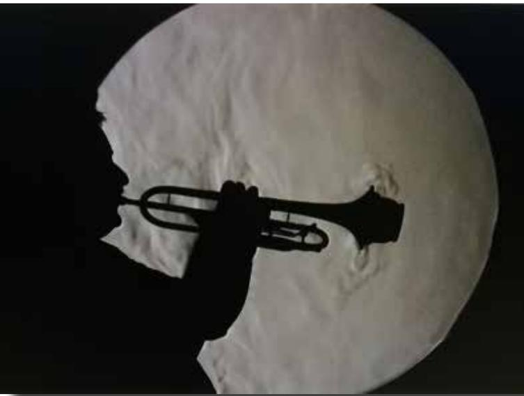
Mithilfe des Schlierenverfahrens wird sichtbar, wie weit die ausgestossene Luft beim Spielen von Blasinstrumenten, z.B. einer Trompete, in den Raum reicht. © Bauhaus-Universität Weimar
